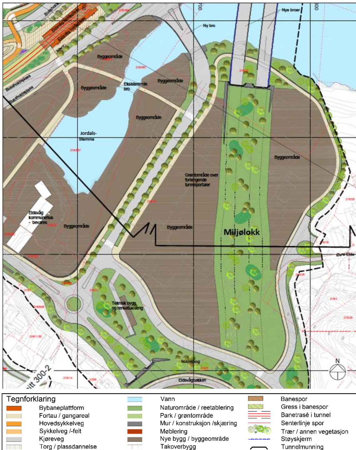
Figur 4-2: Utsnitt av illustrasjonsplan i østre del av Eidsvåg. Plangrense med stiplet svart linje. Svart linje er snittlinje, se snitt Figur 4-3.
