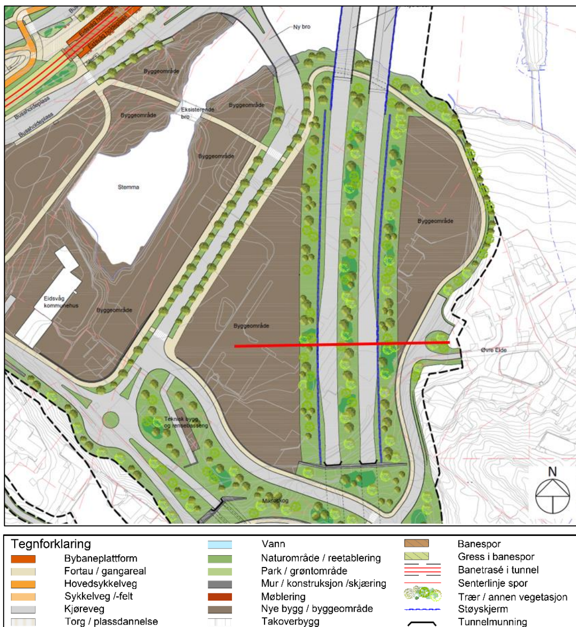
Figur 4-5: Illustrasjonsplan for en situasjon uten miljølokk. Plangrense med svart stiplet strek. Rød linje er snittlinje, se snitt Figur 4-6.
