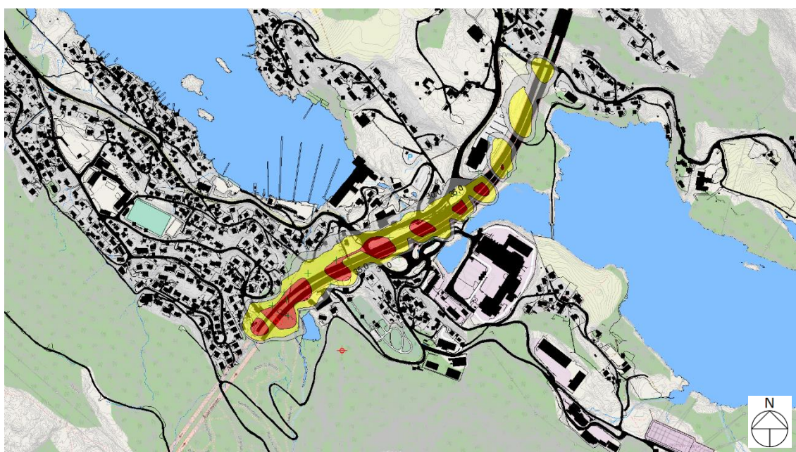
Figur 7-1: Rød og gul luftforurensningszone for PM 10 etter T-1520 for modellering av dagens situasjon (2040). Viser 8. høyeste/ verste døgnnet i året, dvs at i 7 døgn er det verre, og i 357 døgn er det bedre enn det som er vist.
